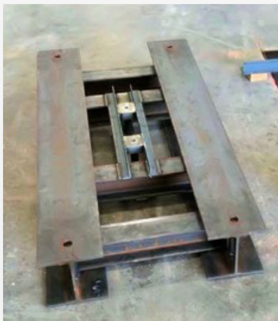
ATW, VTW, 及 AIT-238 机器安装前的安装垫
